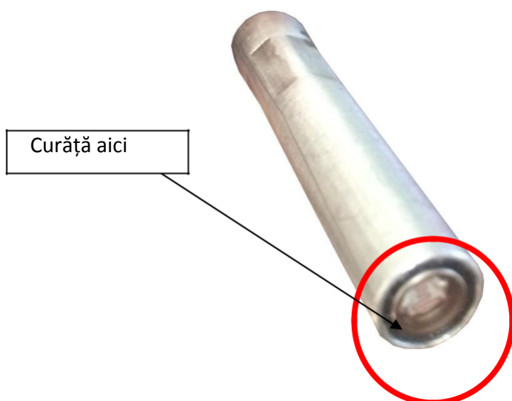
Fig. 6 - Întreținerea fotocelulei și curățarea camerei de presiune (continuare)
